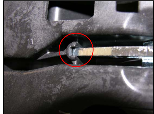
Figura 18a: Dientes de acero asentado en ranura
