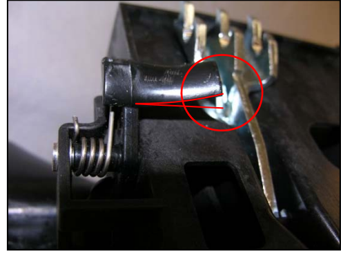
Figura 20: Pie de bandera indicadora deformado
