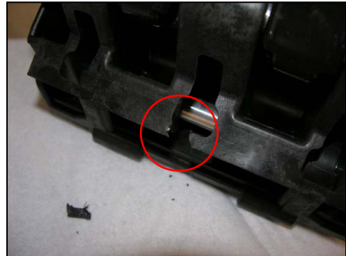
Figura 6: Estante frontal de plataforma quebrado
